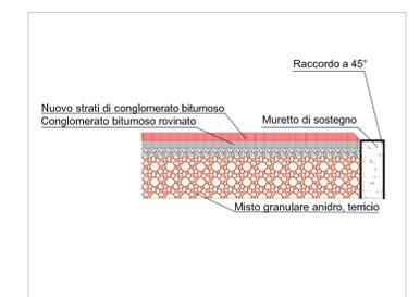
Particolare muro a valle - in progetto - scala 1:50
